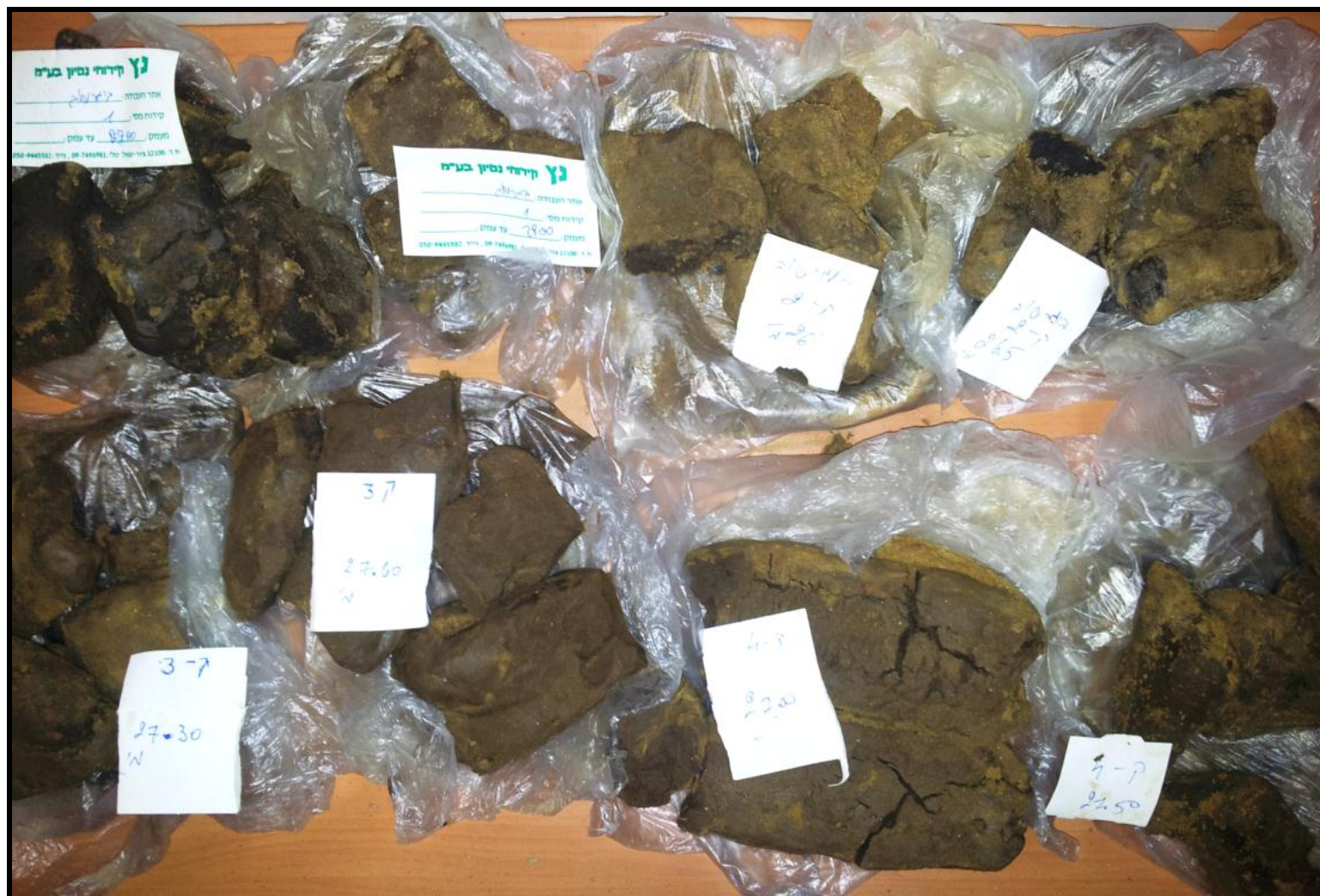
נספח 3 – דוגמאות חרסית מעומק 26-27 מ', כפי שנלקחו מקידוחי סקר קרקע ק-4-1.
